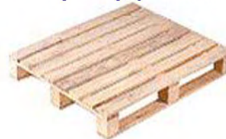
Pallet mặt hở, 4 hướng nâng, có 3 thanh viền đáy 4 way entry, open boarded, 3 base
